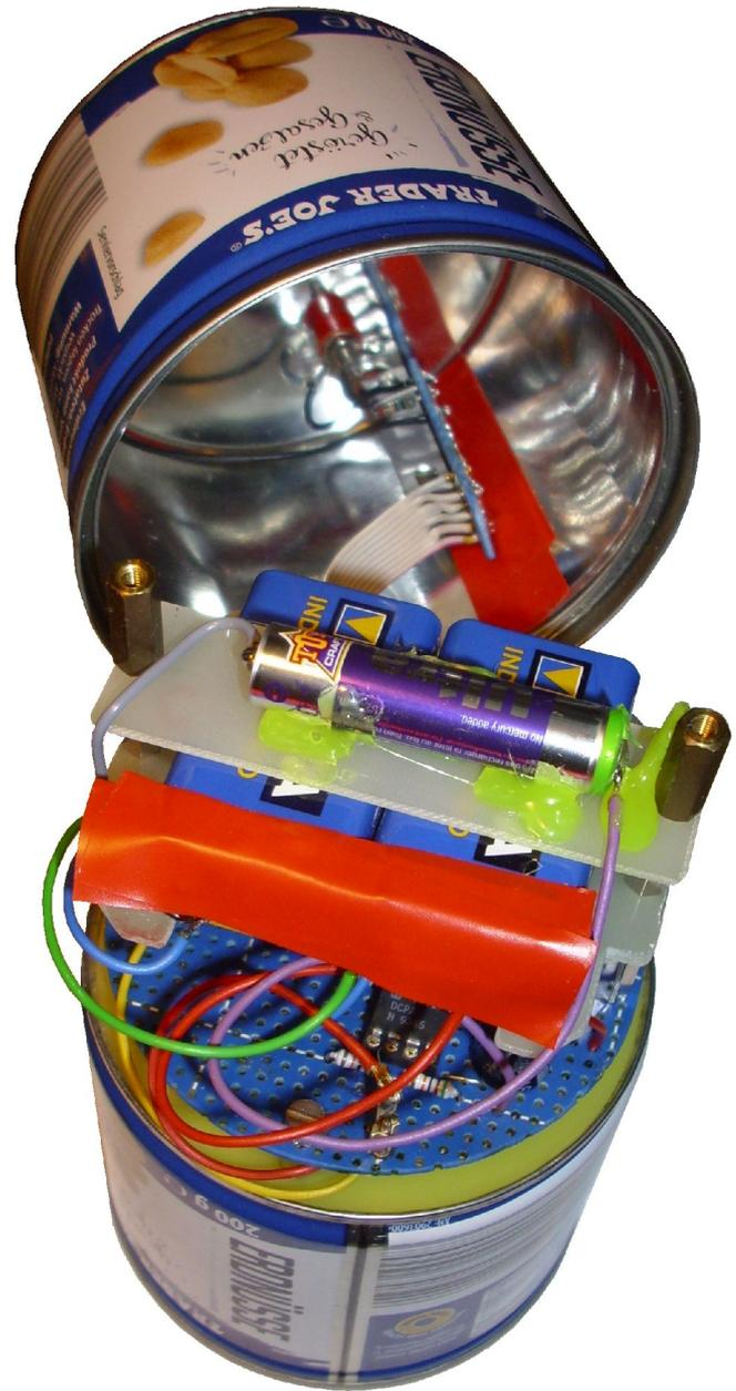
aufschlagt werden, da die Batterien im Detektor auch als Quelle der Anodenspannung benutzt werden (deren Änderungen damit direkt auf die Eingangsstufe rückwirken!!!)
