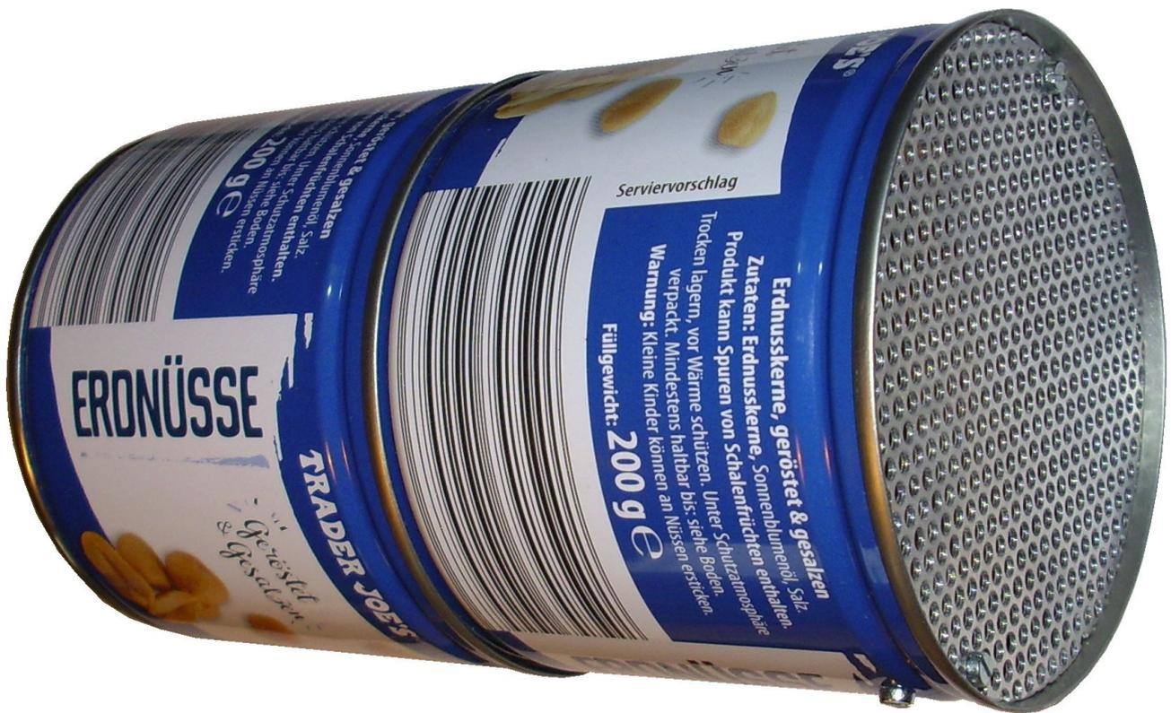
Im Bild oben ist die Lochblechscheibe noch mit zwei M2,5-Zylinderkopfschrauben an diesen Gewindeklötzchen befestigt, was beim Aufstapeln der Bodenseite einer weiteren Dose mechanisch stört (dies ist der Fall, wenn die aufgestapelte Dose z.B. einen Probenraum bereitstellen soll).
